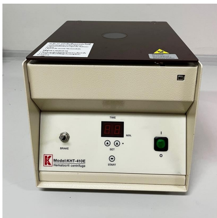
ภาพที่ 32 เครื่องปั่น Hematocrit (Hematocrit centrifuge)
